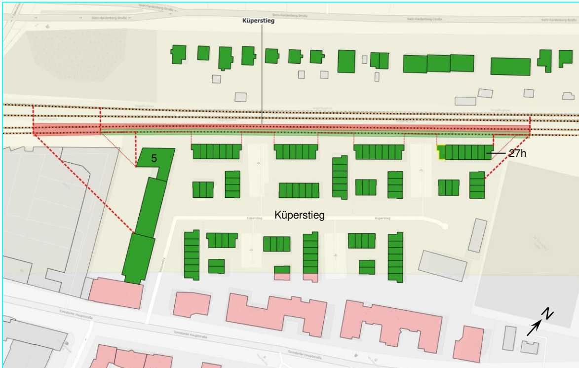
Abbildung 15: Küperstieg, mit Schwellenbesohlung u. abschnittsweise mit Betonrog süd. Fernbahngleis
