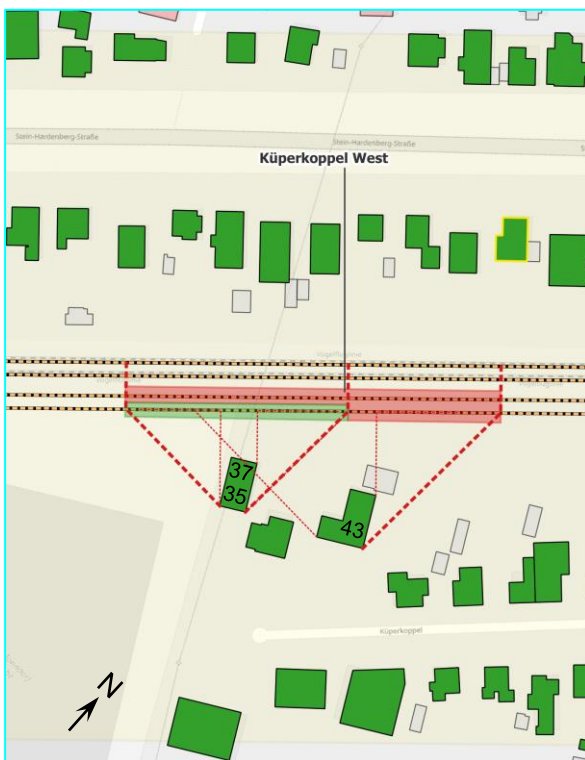
Abbildung 18: Küperkoppel West, mit Schwellenbesohlung auf den Fernbahngleisen u. abschnittsweise mit Betonrog südl. Fernbahngleis
