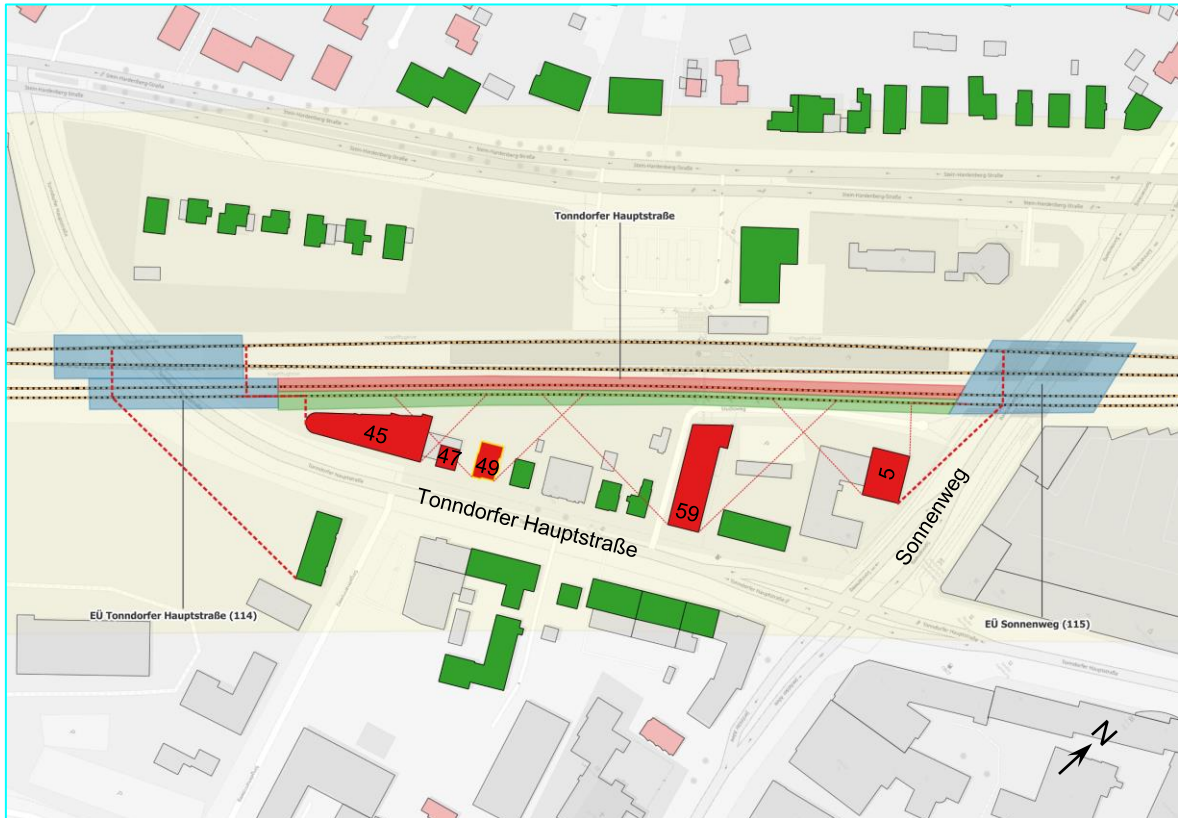
Abbildung 11: Tonndorfer Hauptstraße, mit Schwellenbesohlung nördl. u. Betontrög süd. Fernbahngleis
