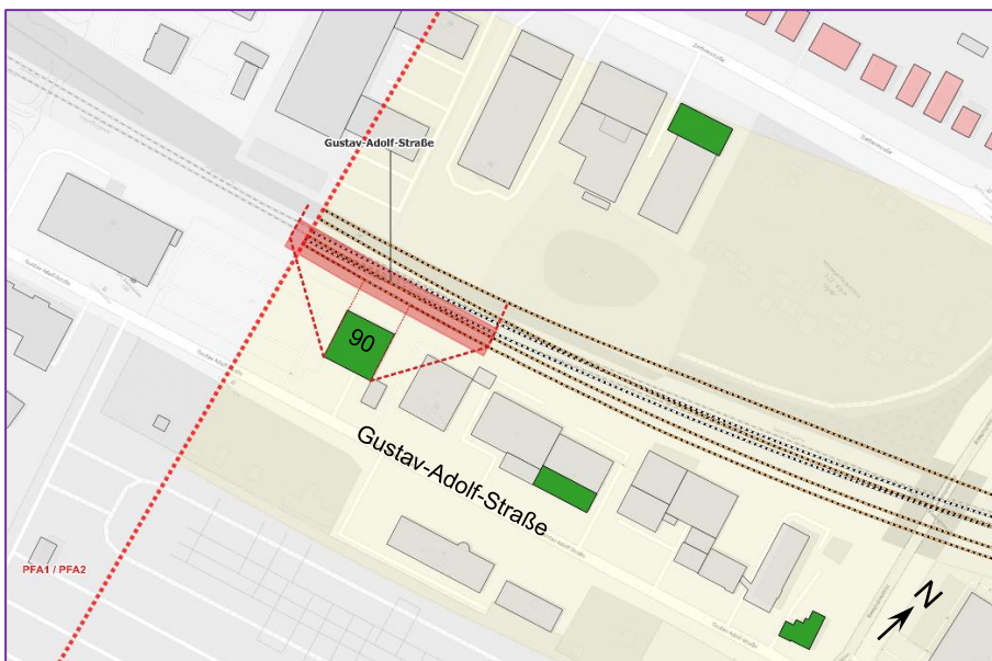
Abbildung 8: Abschnitt Gustav-Adolph-Straße, mit Schwellenbesohlung auf den Fernbahngleisen
