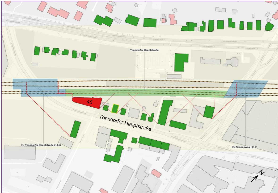
Abbildung 12: Tonndorfer Hauptstraße, mit Schwellenbesohlung u. abschnittsweise Betontrög auf beiden Fernbahngleisen
