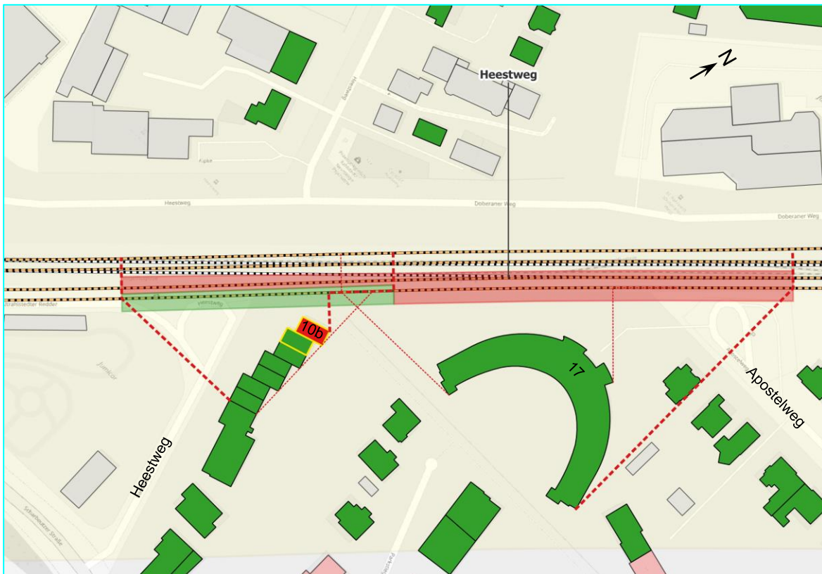
Abbildung 26: Heestweg und Apostelweg, mit Schwellenbesohlung u. abschnittsweise Betonrog süd. Fernbahngleis
