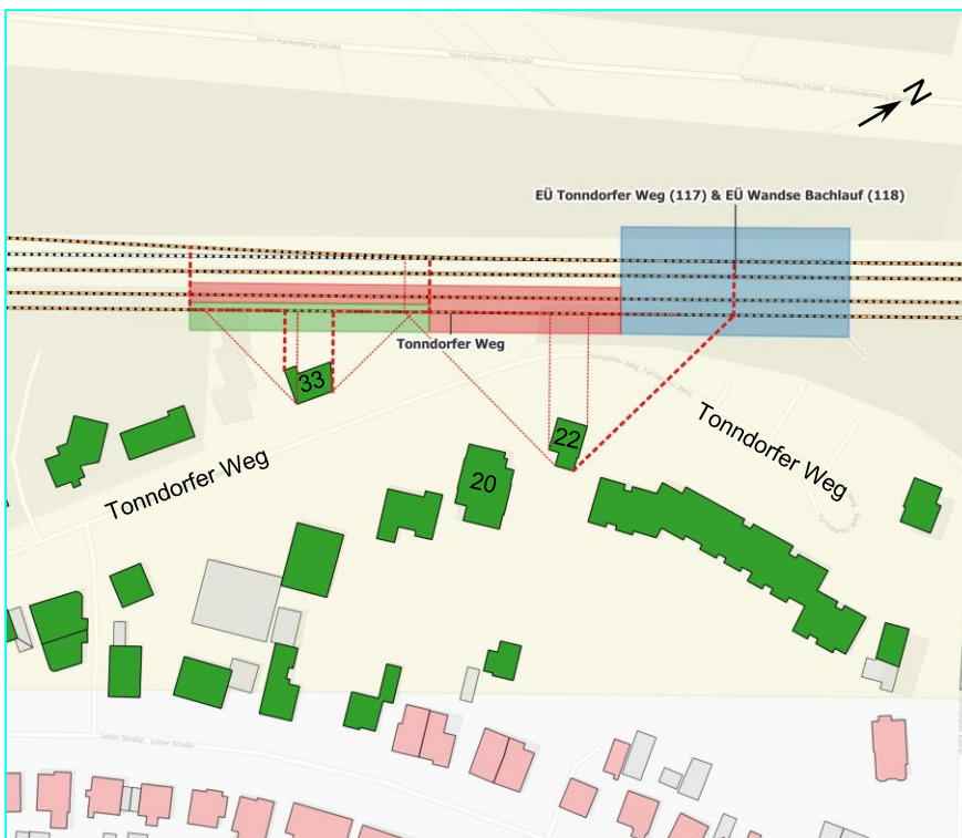
Abbildung 23: Tonndorfer Weg mit Schwellenbesohlung auf den Fernbahngleisen u. abschnittsweise Betontrog auf dem südlichen Fernbahngleis
